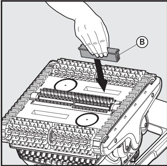
3. Stecken Sie den Saug-Stecker in die Ansaugöffnung, die sich auf der gegenüberliegenden Seite des Saug-Adapters befindet. Um den Saug-Stecker zu entfernen, auf die Laschen (B) auf beiden Seiten des Steckers drücken, und ziehen.
