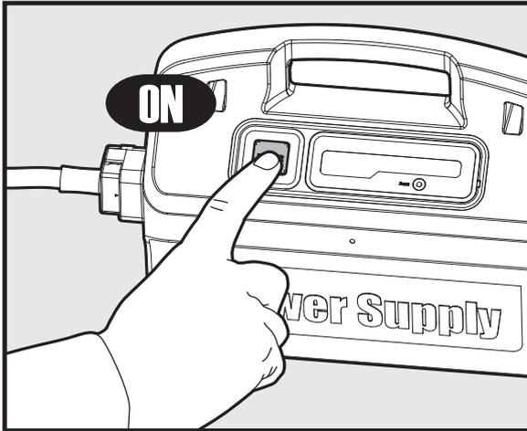
Schalten Sie die Stromversorgung an. Der Roboter wird nun mit einem kompletten Reinigungsvorgang beginnen. Am Ende des Zyklus, wird er sich automatisch wieder ausschalten.
