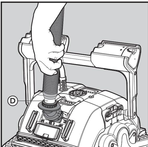
6. Verbinden Sie das schwimmende Kabel mit dem Saugrohr, mit Hilfe der beigeferten Klammer-Anschlüsse (10 Einheiten).
