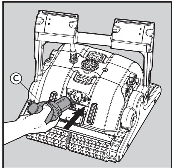
5. Verbinden Sie das Saugrohr mit dem Drehbaren Rohrverbinder, indem Sie das Rohr gegen die schwarze Sicherungsmutter drücken. Das Rohr nicht zu fest gegen die Sicherungsmutter ziehen. Stellen Sie sicher, dass eine kleine Lücke zwischen der Sicherungsmutter und dem Rohr (D) bleibt.
