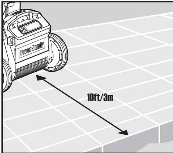
Positionieren Sie das Stromversorgungsgerät so, dass es sich in einem Abstand von ungefähr 3m / 10ft in der Mitte der Pool Längsseite befindet.
