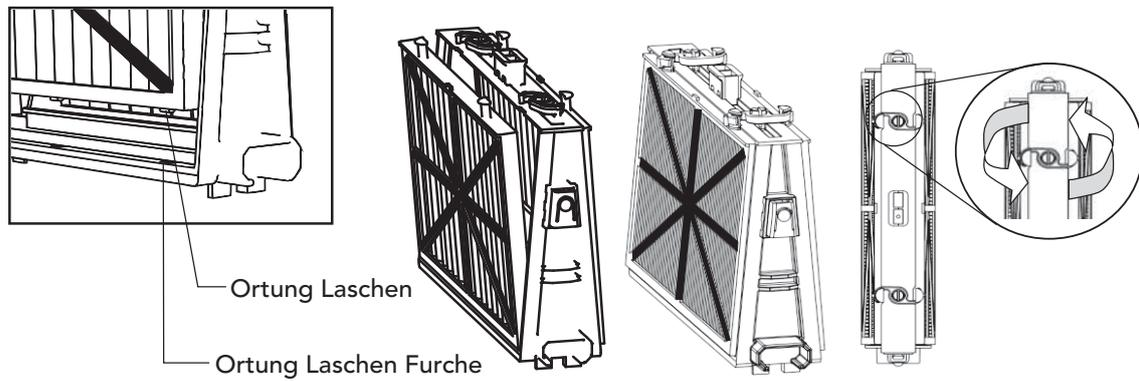
Installieren Sie den Grundrahmen mit den Filtern, entsprechend dem Diagramm.
