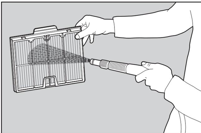
**6.2.4** Den Filter mit einem Schlauch reinigen.
