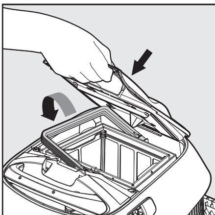
**6.2.6** Den sauberen Filterkorb einsetzen und den Filterdeckel schließen.
