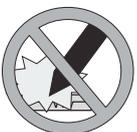
Berühren Sie die UV-Lampe niemals mit bloßen Händen oder mit scharfen Gegenständen. Natürliche Hautfette führen zu vorzeitigem Ausfall. Entfernen oder ersetzen Sie das UV-Licht nicht. Das Licht ist fest montiert und nicht durch den Bediener zu ersetzen.
